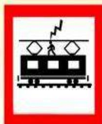
**Влезать на вагоны. Напряжение в проводах достигает 27500 вольт. (дома в электрической розетке-220 вольт). Смертельный ожог может произойти на расстоянии 1-2 метров от контактного провода!**
